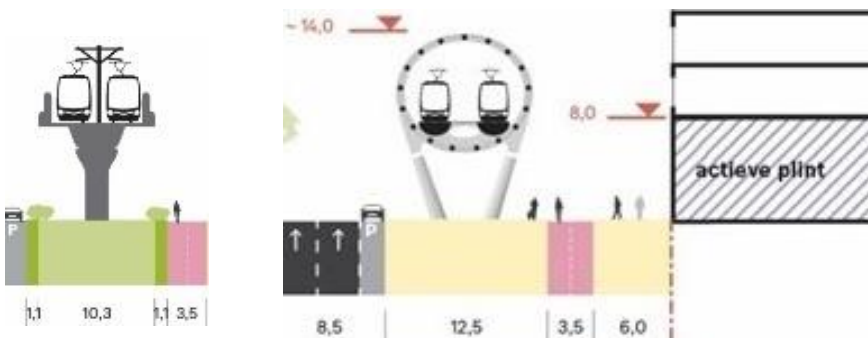
Figuur 2-52 Schematische weergave compacte constructie lightrail (links) en een netkousconstructie (rechts)
